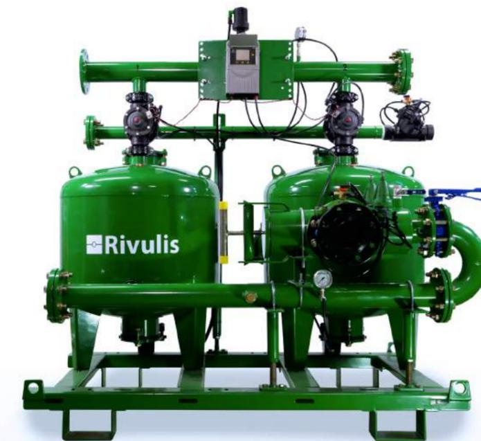
La filtration est un élément primordial d'une installation de goutte à goutte. Pour un bon fonctionnement, elle doit être de 100 microns et avoir une surface filtrante adaptée à l'origine de l'eau et au débit demandé.
